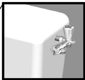
A l'aide d'une clé plate de 19, monter votre robinet sur votre entrée de réservoir de chasse sans oublier de mettre un joint fibre fourni dans le kit. (ATTENTION AU SERRAGE DE L'ECROU NE PAS DEPASSER 15Nm).
