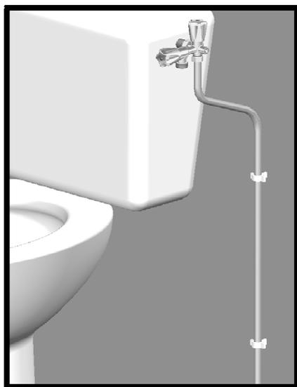
Ensuite raccorder votre réseau à l'entrée 3/8" mâle du robinet sans oublier le joint fibre fourni (privilégier une alimentation tube cuivre, et/ou limiter les efforts générés par la tuyauterie sur le robinet en plaçant des colliers à espacement régulier sur la canalisation).
